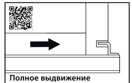
Выдвиньте подвижные элементы направляющих, вставьте ящик и задвиньте до щелчка. Крючки направляющих должны войти в зацепление с отверстиями в задней стенке ящика.
