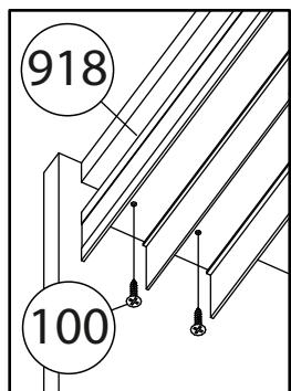
Верхнюю направляющую закрепить саморезами, нижнюю направляющую приклеить
