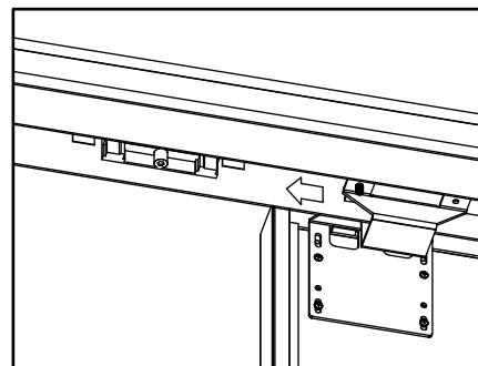
Взведите доводчик и зафиксируйте ответную планку. Проверьте работу доводчика. Если остался зазор между боковиной и торцевой поверхностью фасада, то отрегулируйте положение ответной планки при помощи овальных отверстий.
