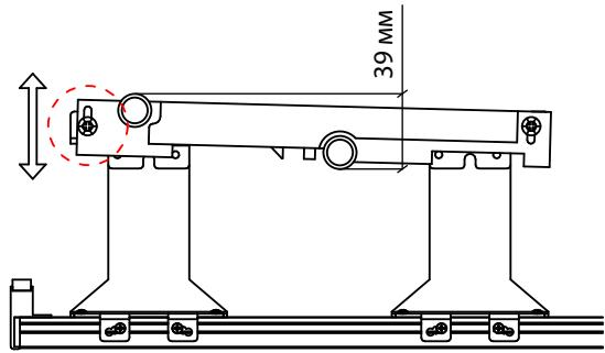
Зафиксируйте доводчик таким образом, чтобы его край совпадал с краем кронштейна
