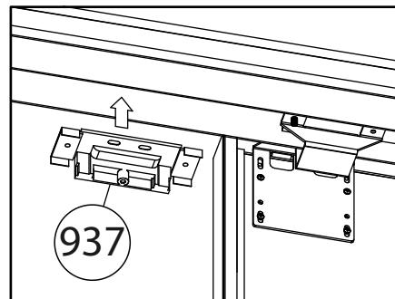
Взведите доводчик и зафиксируйте ответную планку. Проверьте работу доводчика. Если остался зазор между боковиной и торцевой поверхностью фасада, то отрегулируйте положение ответной планки при помощи овальных отверстий.
