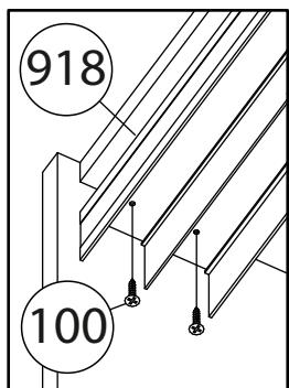
Верхнюю направляющую закрепить саморезами, нижнюю направляющую приклеить
