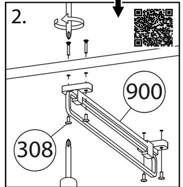
При глубине шкафа менее 500 мм вместо штанги устанавливаются выдвижные кронштейны (1 штанга = 1 кронштейн).
