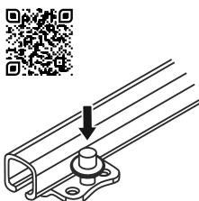
В комплект направляющих скрытого монтажа частично-го выдвижения не входят фиксаторы. Функцию фикса-тора выполняет штырь направляющих.
