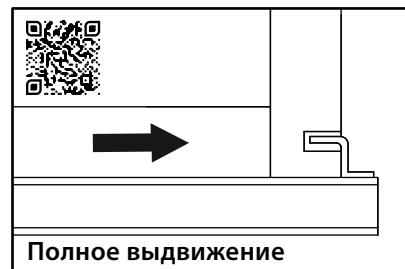
Выдвиньте подвижные элементы направляющих, вставьте ящик. Крючки направляющих должны войти в зацепление с отверстиями в задней стенке ящика. Опуская ящик вниз, нужно насадить стенки боковыми отверстиями на штыри направляющих. После установки ящика на направляющие отрегулируйте зазоры по высоте, вращая шайбу с накаткой.
