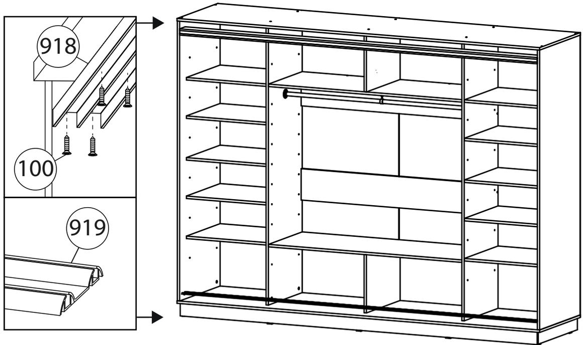
Закрепить верхнюю направляющую саморезами. Верхняя направляющая ставится заподлицо с боковыми стенками шкафа, нижняя направляющая ставится на дно с отступом 18 мм от края.
