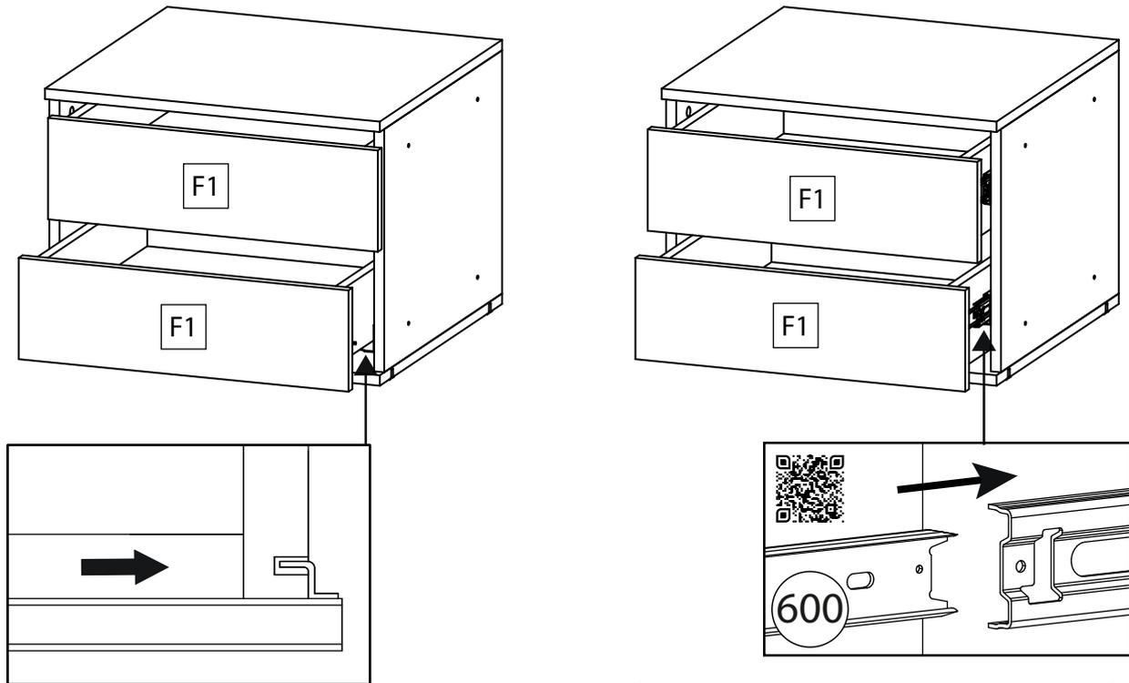
Выдвиньте подвижные элементы направляющих, вставьте ящик и задвиньте до щелчка. Крючки направляющих должны войти в зацепление с отверстиями в задней стенке ящика.
