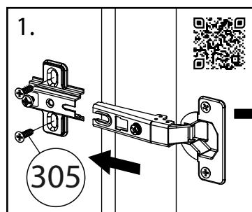
Плечо петли надвигается на ответную планку и фиксируется винтом
