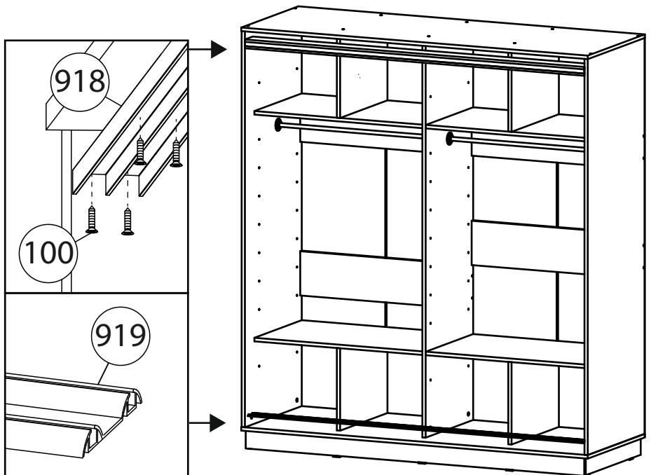
Закрепить верхнюю направляющую саморезами. Верхняя направляющая ставится заподлицо с боковыми стенками шкафа, нижняя направляющая ставится на дно с отступом 18 мм от края.
