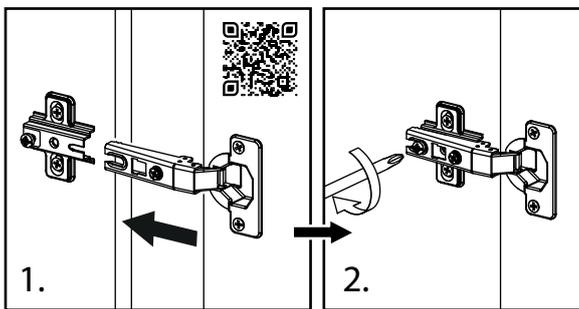
Плеcho петли надвигается на ответную планку и фиксируется винтом
