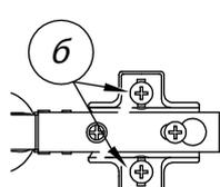
**в** - регулировка положения двери по горизонтали
