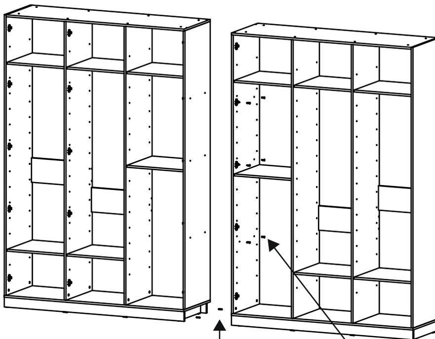
Перегородки стягиваются между собой межсекционными стяжками. Предварительно в соприкасающихся перегородках под стяжки просверливаются сквозные отверстия диаметром 5 мм.
