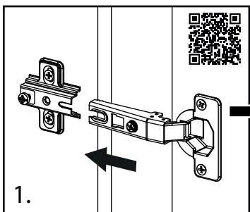
Плечо петли надвигается на ответную планку и фиксируется винтом
