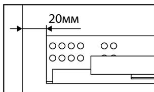
В комплект направляющих скрытого монтажа полного выдвижения входят: фиксаторы левый и правый, направляющие левая и правая. Фиксаторы устанавливаются на дно ящика, а направляющие на боковины корпуса. Разъединение производится путем нажатия на рычаги фиксаторов. Если направляющие крепятся на одной боковине с двух сторон, то саморезы необходимо крепить в разные отверстия направляющей. Для регулировки выкатных ящиков по высоте необходимо повернуть регулировочное колесо на фиксаторе (см. рисунок).
