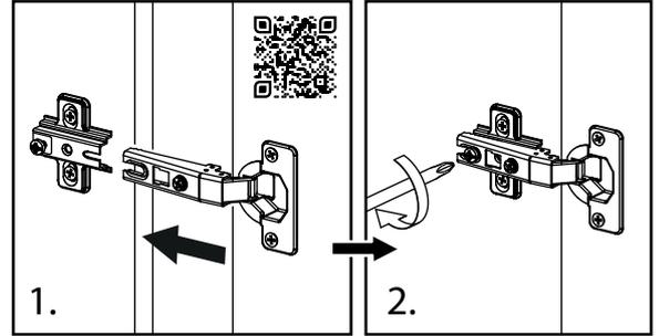
Плечо петли надвигается на ответную планку и фиксируется винтом
